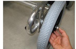
**fig. 1:** Inserimento ruote posteriori
