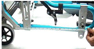
fig. 18: Spostamento piastra ruote
